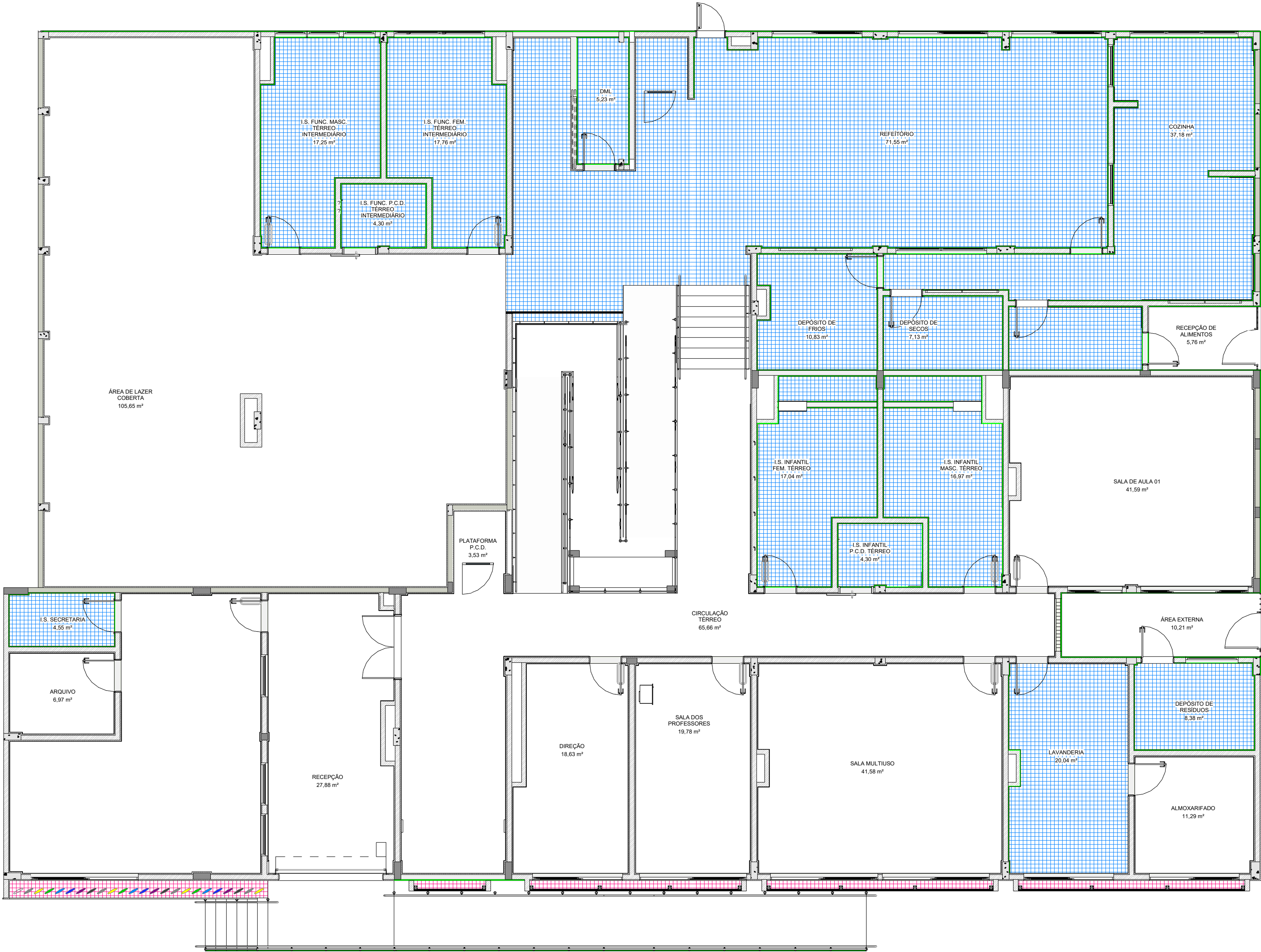
1 TÉRREO - PLANTA DE IMPERMEABILIZAÇÃO 1 : 75
